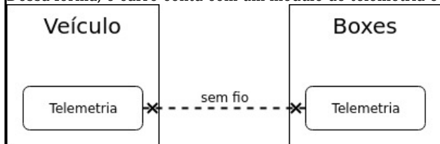
Figura 2: Diagrama de bloco do subsistema telemetria. Fonte: O autor (2018)
